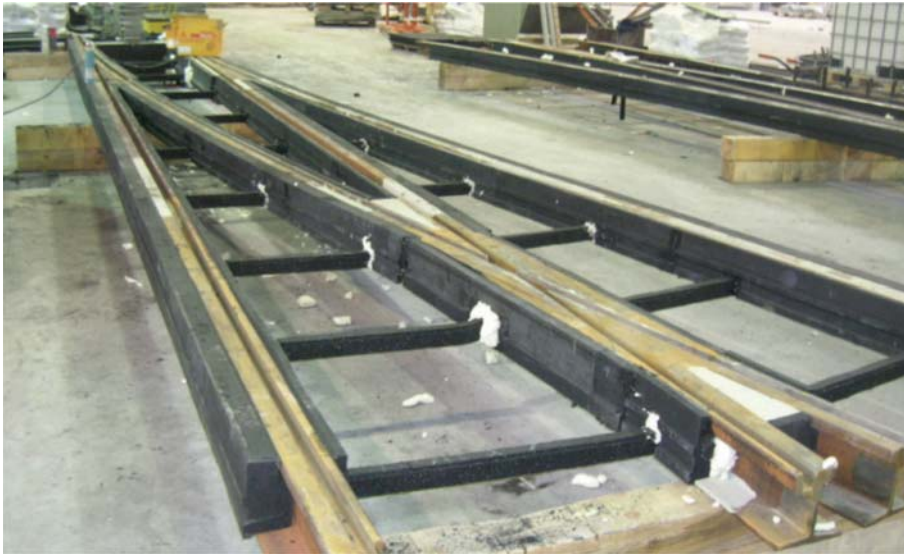
Şekil 8 - Atölye ortamında reçine esaslı kauçuk ceket ile kaplanan basit makas
